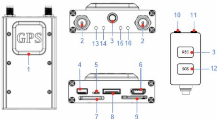
**1-Antenna GPS, 2- Antenna LTE, 3- Pulsante di accensione/registrazione, 4- Porta per controller esterno, 5- Microfono, 6- Porta alimentazione Micro USB, 7- Slot per scheda micro SD, 8- Porta per il collegamento di una fotocamera , 9- Slot SIM, 10- Connettore per collegamento esterno delle cuffie al controller, 11- Video IN, 12- Pulsante SOS, 13-16 Diodi di segnale**
