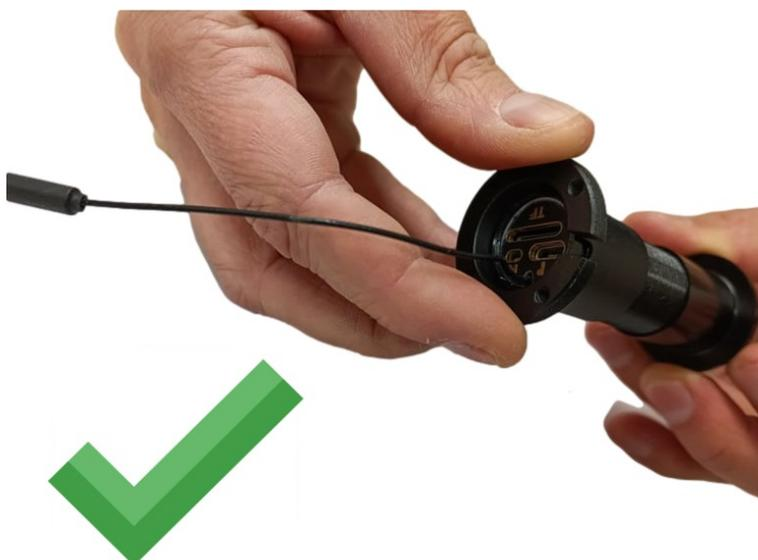
1. Si prega di fare attenzione durante lo smontaggio per non torcere l'antenna. Se l'antenna si blocca sull'anello, c'è il rischio di danneggiarla.
